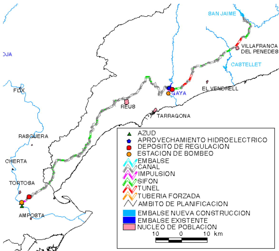
Figura 71. Características de la solución 3 del trasvase Bajo Ebro-Llobregat
