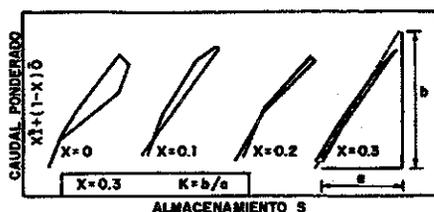
Fig. 5.2.—Ajuste de los parámetros del Método de Muskingum
