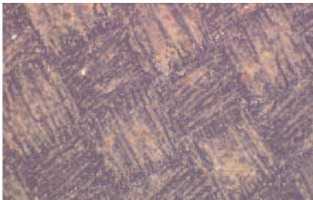
FIGURA 5. Microfotografía de EPDM (x60), cara externa, del campo experimental de El Saltadero a los 6 años de su instalación por microscopia óptica de reflexión.
