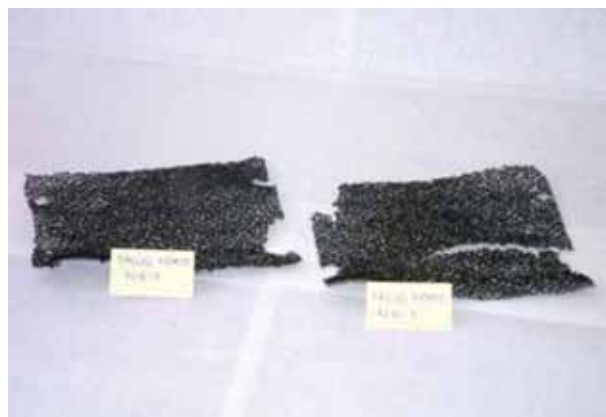
FIGURA 11. Estado de las probetas extraídas de obra tras el ensayo en medio alcalino.
