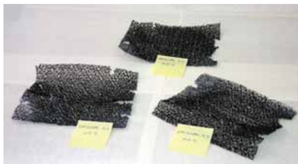
FIGURA 9. Probetas de geoesteras de los materiales originales tras el contacto con el medio alcalino.
