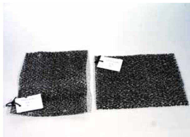
FIGURA 6. Geostera del geodrén.
