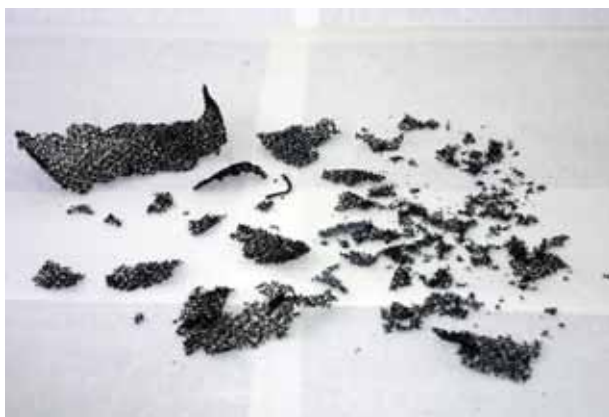
FIGURA 10. Estado de la geoestera del rollo 2 tras sus tres ciclos de tratamiento con el hidróxido cálcico.
