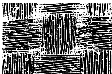
FIGURA 29. Muestra de EPDM procedente del embalse de Bullas (Murcia) observada por su cara externa mediante microscopía electrónica de barrido (MEB) a 90 aumentos, extraída a los seis años de su puesta en obra.
