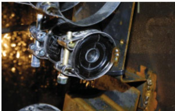
**FIGURA 10.** Cámara de video sumergible ubicada en el desagüe de fondo situada ya en las sujeciones diseñadas para el ensayo.
