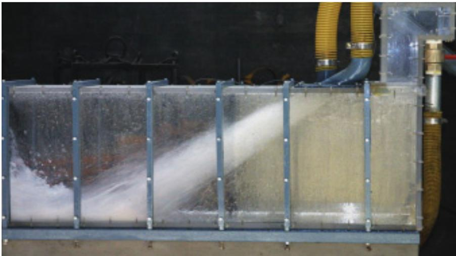
FIGURA 28. Funcionamiento del by-pass inclinado 30°.  $V = 17$  m/s. de prototipo. Se aprecia el buen funcionamiento.
