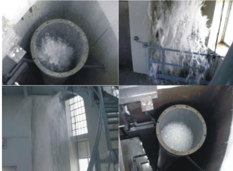
**FIGURA 15.** Imágenes del prototipo en la que se aprecia diferentes instantes del lanzamiento del agua.
