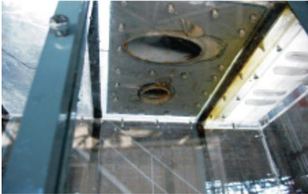
FIGURA 27. Detalle de la salida del by-pass a 30° paralelo al inicial.
