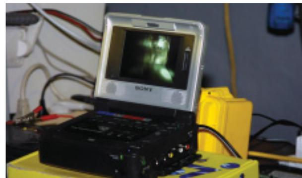
**FIGURA 11.** Video reproductor portátil que permitía ver las imágenes que captaba la cámara sumergible durante los ensayos y grabarlas para su posterior análisis.
