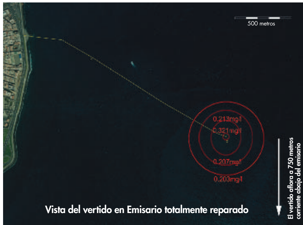
FIGURA 18. Fotografía aérea del vertido con las concentraciones del modelo para un vertido de 600 l/s, una corriente marina hacia el sur de 0.3 m/s y 445 mg/l de concentración de sustancia conservativa, vertido por los difusores según el proyecto. En este caso el vertido afloraría a 750 metros corriente abajo.
