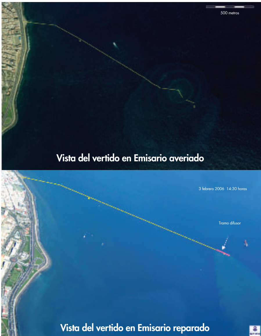
FIGURA 21. Vista aérea del vertido con el emisario averiado y reparado.
