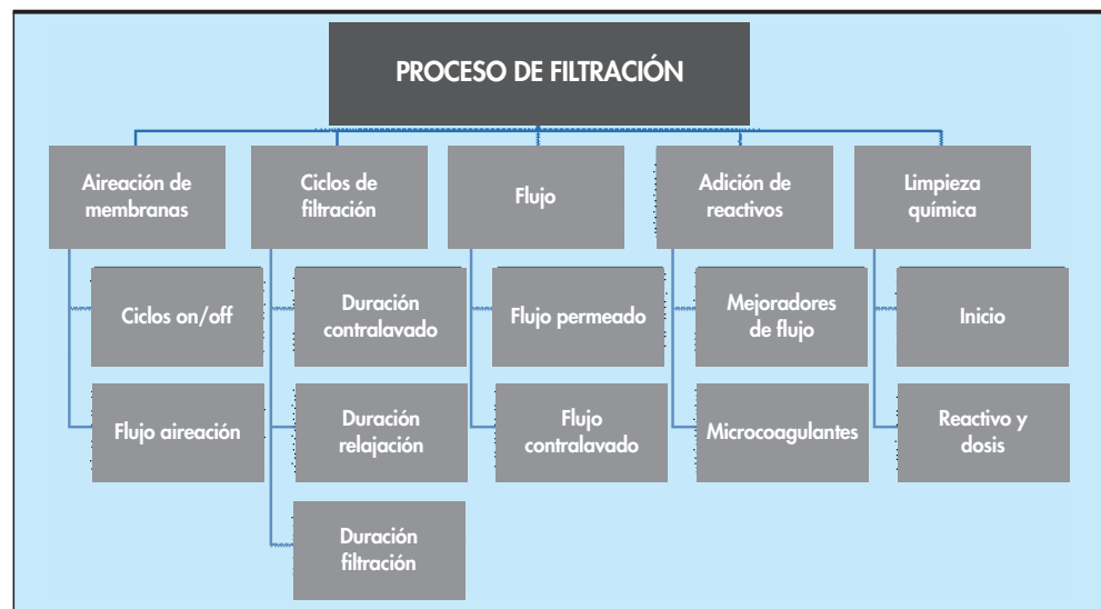
FIGURA 8. Puntos de control del proceso de filtración de un MBR (Ferrero et al, 2012).
