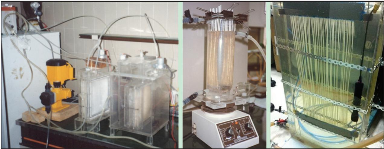
FIGURA 4. Plantas piloto para el estudio de RBSOM con membranas planas (a), tubulares (b) y de fibra hueca (c).
