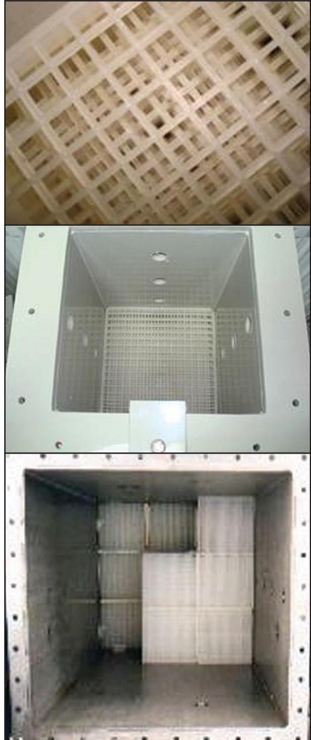
FIGURA 1. Medio Soporte BLAS: detalle del solapamiento entre mallas y montaje en prototipo a escalas de bancada (60 l) y piloto (1 m<sup>3</sup>). [Las fotografías tienen distintas escalas].
