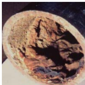
Fig. 3 – Ejemplo de tubería de acero con corrosión interior y tubería de acero inoxidable con una fuga.
