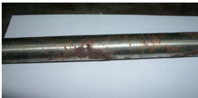
Fig. 8 Corrosión de un tubo de acero inoxidable
