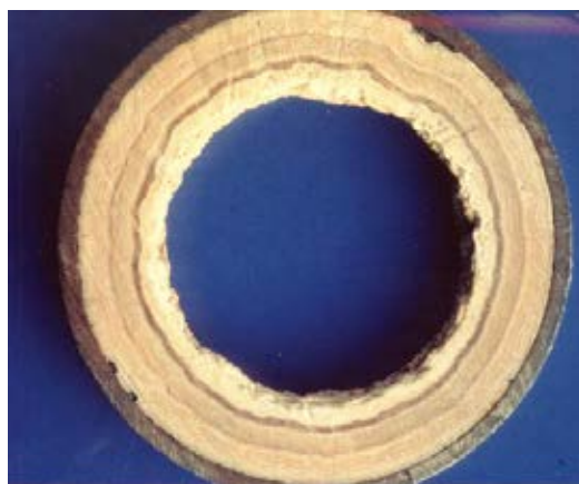
Fig.5: Capas de incrustación calcárea en el interior de una tubería de acero.
