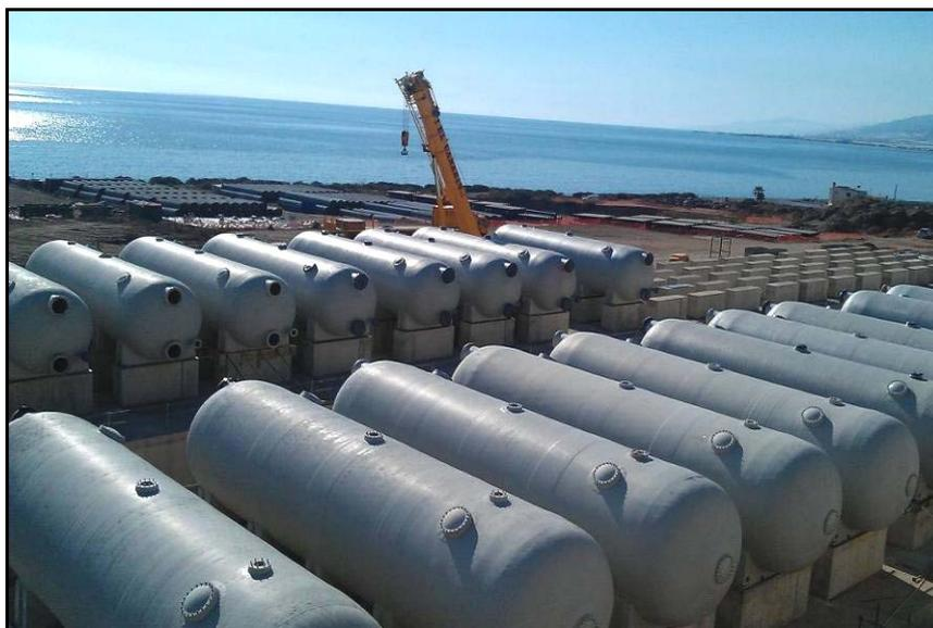
*Figura 7. Filtros bicapa a presión contruidos en PRFV*
