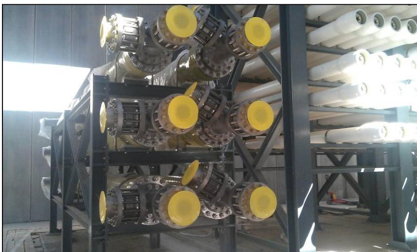
*Figura 4. Tren de recuperación de energía*
