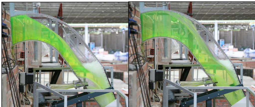
Figura 20. Fotos del sifón en fases estables de cebado parcial
