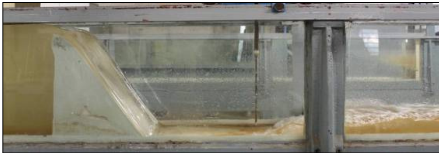
Figura 10. Resalto forzado en el modelo físico. El calado medio aguas abajo es de 8,0 cm (con fluctuaciones entre 7 y 9 cm)
