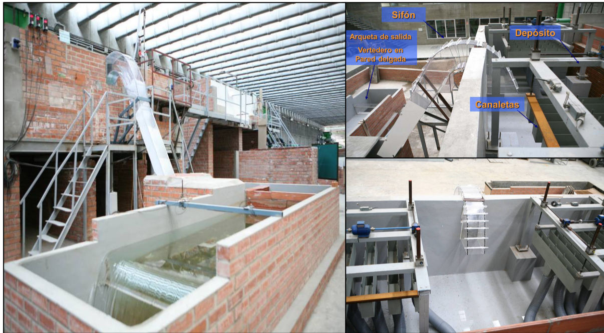
Figura 15. Instalaciones del Laboratorio de Hidráulica del CEH-CEDEX para ensayar sifones
