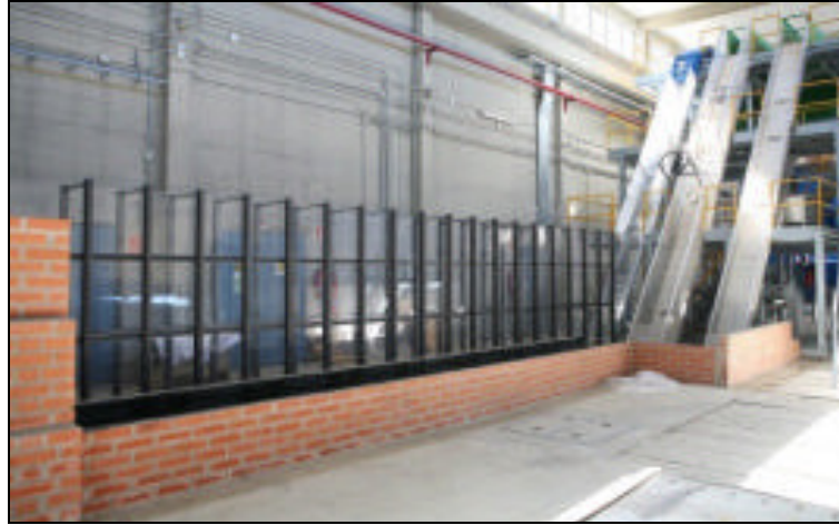
Figura 4. Diseño experimental para modelos físicos de gran escala representativos de rápidas y cuencos amortiguadores simples y tipificados. Instalación para experimentación de la aireación forzada en aliviaderos (CEH, CEDEX).
