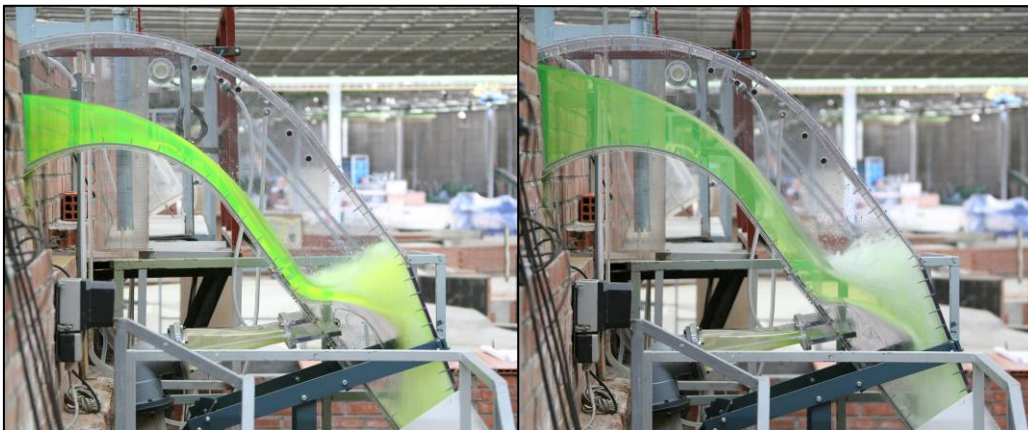
Figura 19. Fotos del sifón en fases iniciales estables de cebado parcial
