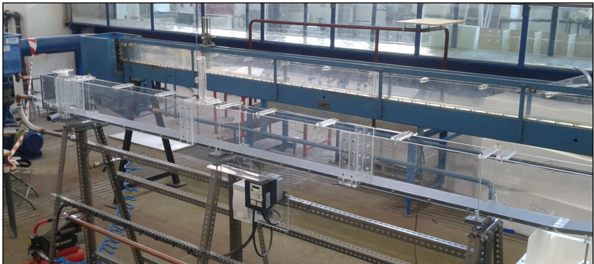
Figura 3. Canal construido para el emulsionamiento del flujo (UPV).
