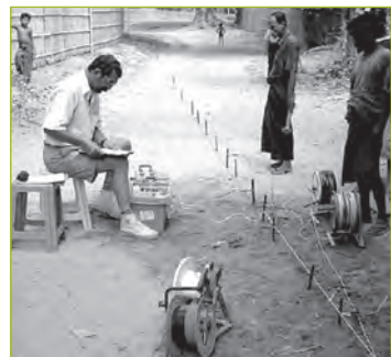
Géophysique (panneau électrique en Afrique)
