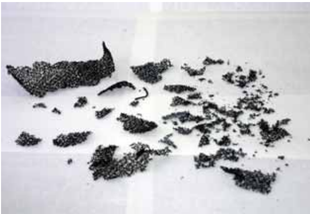
FIGURA 10. Estado de la geoestera del rollo 2 tras sus tres ciclos de tratamiento con el hidróxido cálcico.
