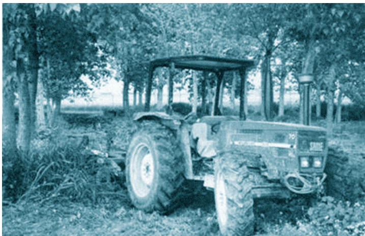
FOTOGRAFÍA 10. Pase de grada en una instalación de filtro verde.
