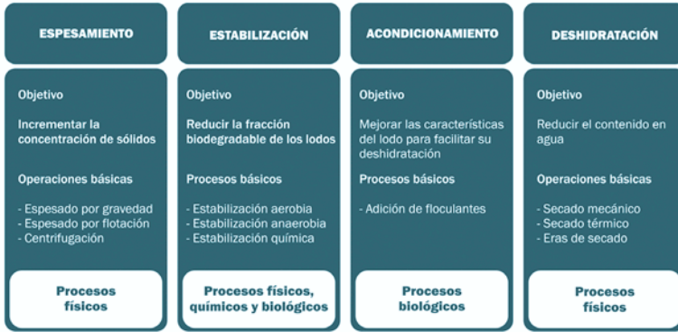
FIGURA 8 Tratamientos en la línea de lodos.
