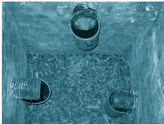
FOTOGRAFÍA 9. Vista superior de un lisímetro, en la que se aprecian las tuberías de toma de muestras ubicadas a distintas profundidades.
