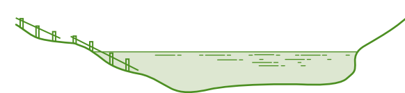
Figura a2. Dos escalas inclinadas sobre la zona litoral de la cubeta.
