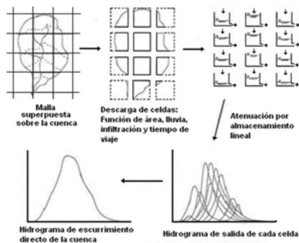
Fig. 2.5. Modelo de escurrimiento directo conceptual ModClark para parámetros distribuidos (Fuente: Evolution of Clark's Unit Graphs Method to Spatially Distributed Runoff; Kull D. W. and Feldman A. D., 1998)
